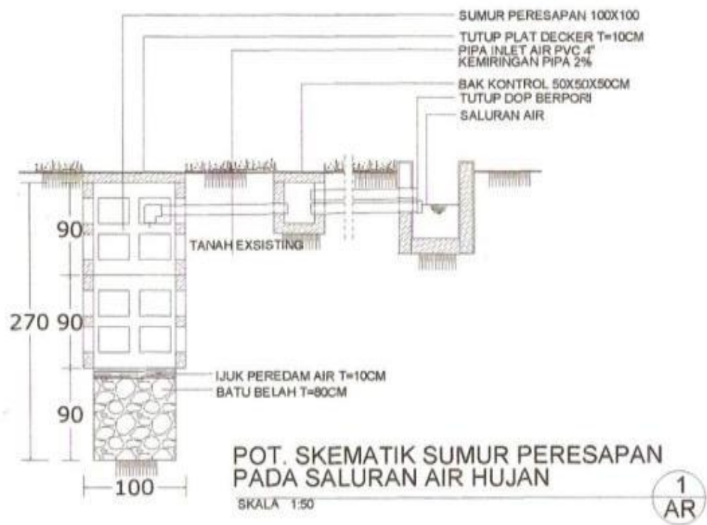
Gambar 2.13 Contoh desain sistem peresapan pada saluran air hujan (tampak samping)
